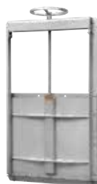
Série 772/61 Vanne murale bidirectionnelle jusqu'à 1200 X 1200 mm Uni ou bidirectionnelle pour les plus grandes dimensions Tige non montante Acier inoxydable AISI 304 200 x 200 mm à 2000 x 2000 mm
