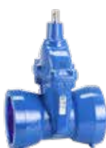
Série 33/00 Vanne avec embouts Tyton pour tuyau fonte DN80-300 PN16 Fonte ductile Revêtement interne émaillé
