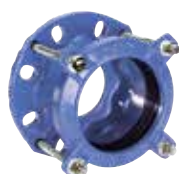
Série 603 Adaptateur grande tolérance Supa® DN40-400 PN10/16 Fonte ductile
